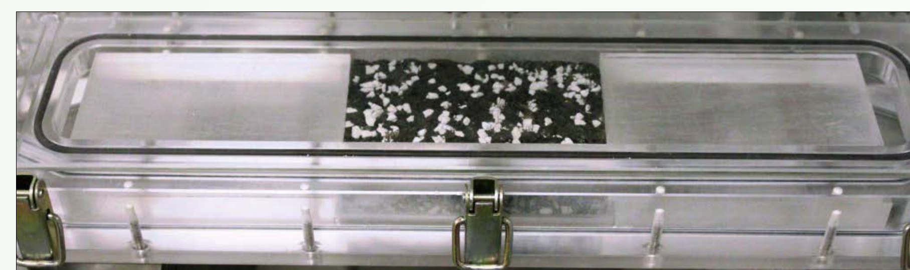
Abb. 5 + 6: Messung des Stickoxidabbaus nach ISO 22197-1
