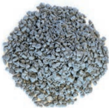
Eigenschaften des AirClean®-GRANULATS (künstliche, gebrochene Gesteinskörnung für Asphalt)
