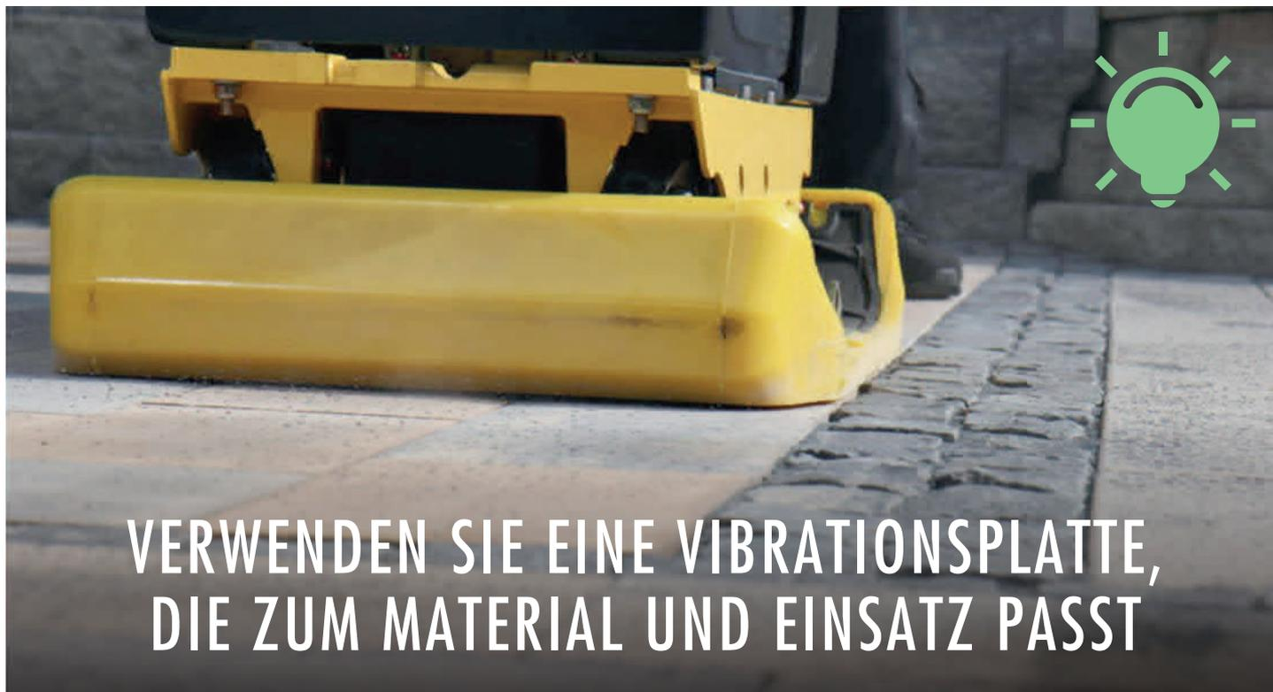
Mit herkömmlichen Verdichtungsgeräten (Bodenverdichter) kann die Bruchrate bei bis zu 30 % liegen.
