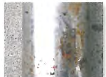
Handelsübliches Edelstahlrohr b) nach Befuerung mit biogenen Brennstoffen
