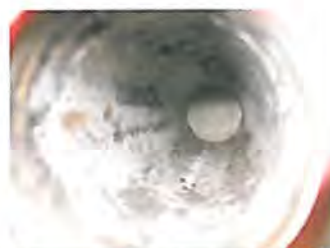
Handelsübliches Edelstahlrohr a) nach Rußbrand
